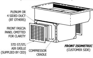
A PLENUM OR 4 SIDED TUNNEL (MADE FROM MDF, PLYWOOD OR NILFLAM TYPE MATERIAL) MUST BE FITTED BETWEEN THE REAR FACE OF THE CUSTOMER SIDE FASCIA PANEL AND THE FRONT FACE OF THE COMPRESSOR CRADLE, AROUND THE AIR INTAKE CUT-OUT, TO STOP THE RE-CIRCULATION OF HOT AIR FROM THE COMPRESSOR. SILICON SEAL AROUND EDGES TO ENSURE THERE ARE NO AIR GAPS.
